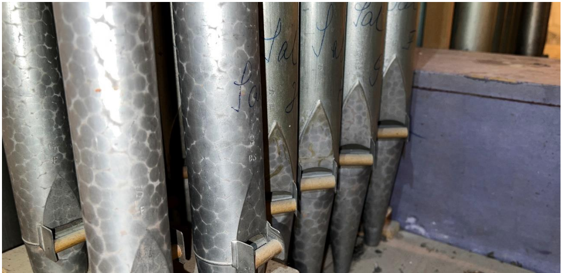
Abbildung 9 Basspfeifen der Streicherregister mit Rollbärte
