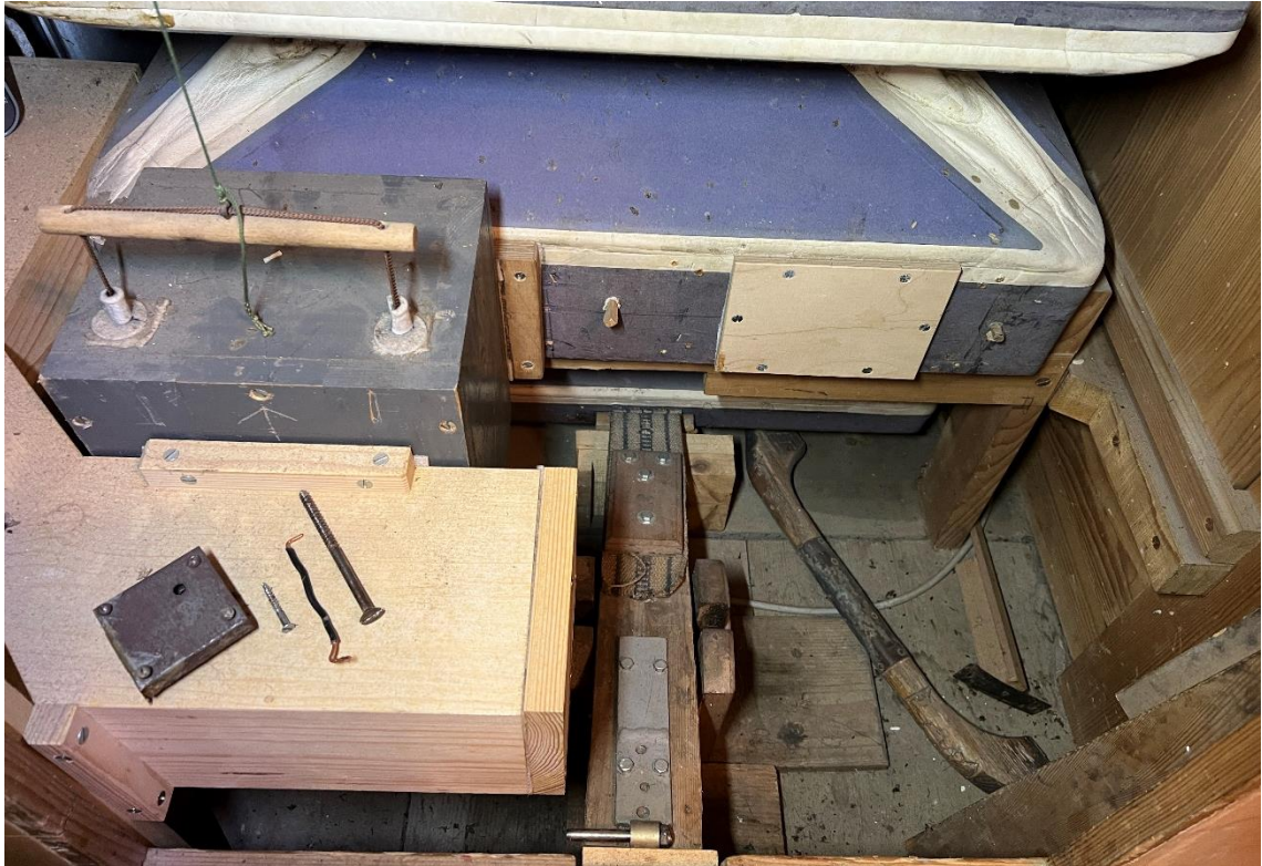
Abbildung 47 Balganlage auf der Cs-Seite v.d.R.
