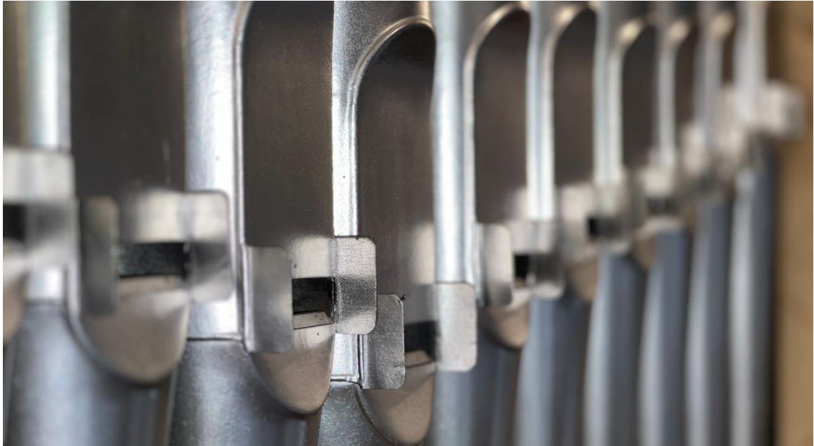
Abbildung 7 Labienbereich und Seitenbärte der Prospektpfeifen
