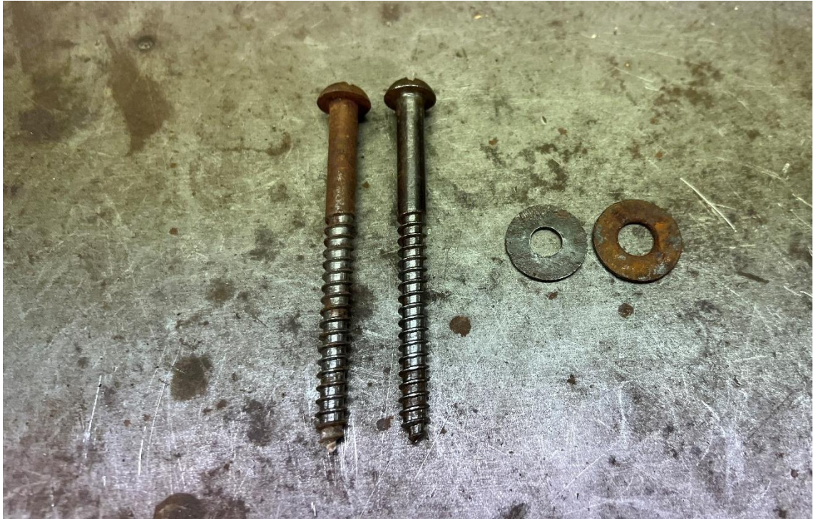
Abbildung 26 Entrostung der Stockschrauben
