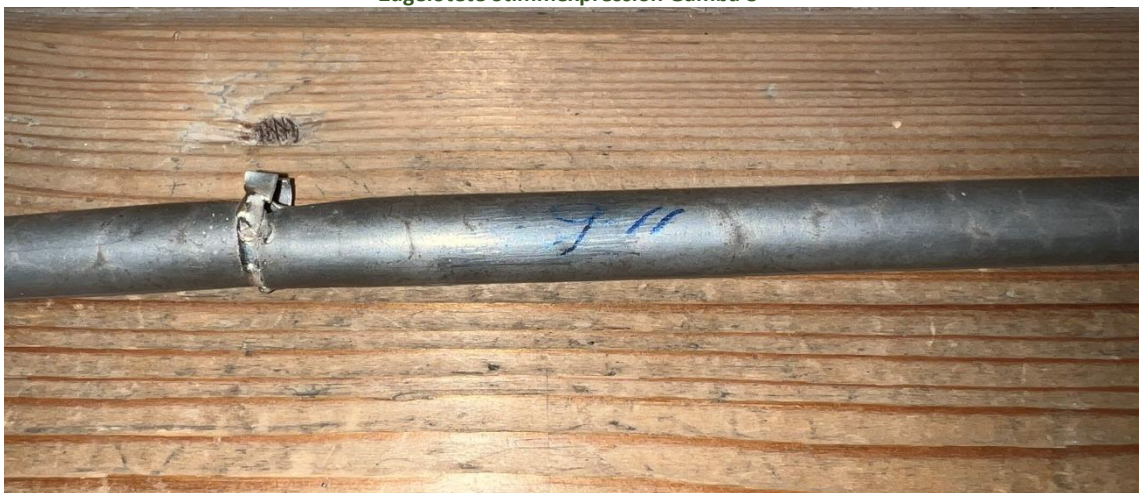
Abbildung 11 Provisorisch angelötete Seitenbärte Salicional 8'
