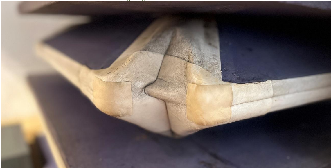
Abbildung 48 Abdichten der Löcher mit Lederstreifen
