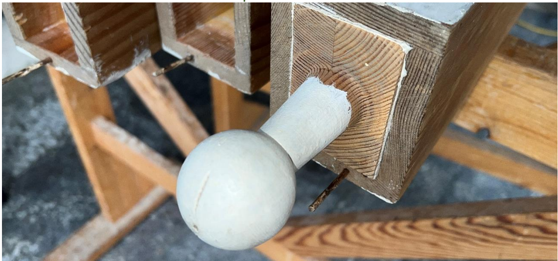
Abbildung 16 Spundgriff Subbass 16' mit Wandfarbe
