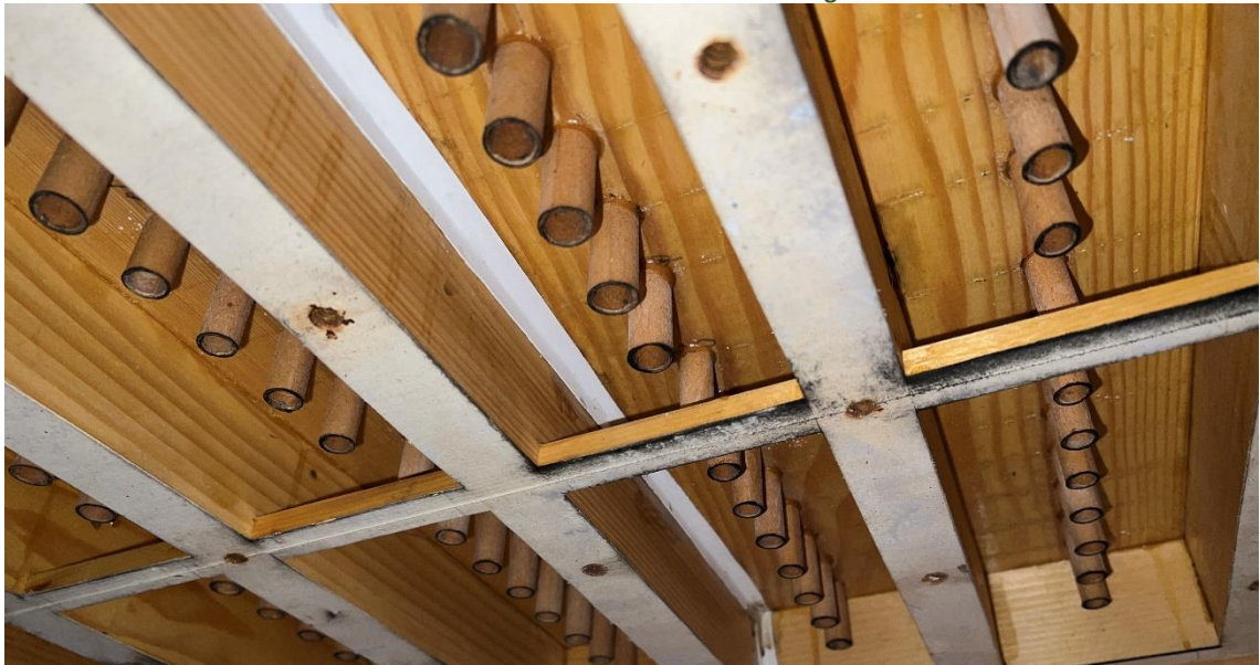
Abbildung 25 Windladenunterseite mit Papprohre
