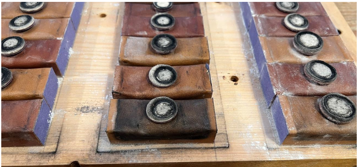
Abbildung 22 Undichte Ledertaschen und Dichtungsscheiben
