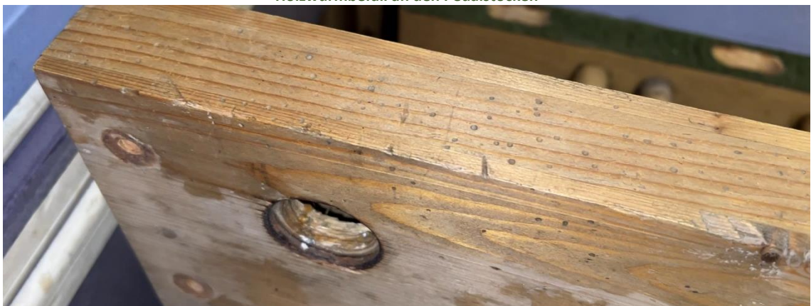
Abbildung 29 Mit Bienenwachs-Leinöl-Paste behandelte Pedalstöcke n.d.R.
