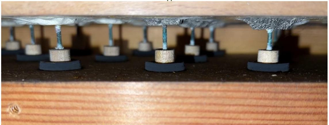
Abbildung 38 Verbrauchte Tellerventile im Manual-Umschaltrelais
