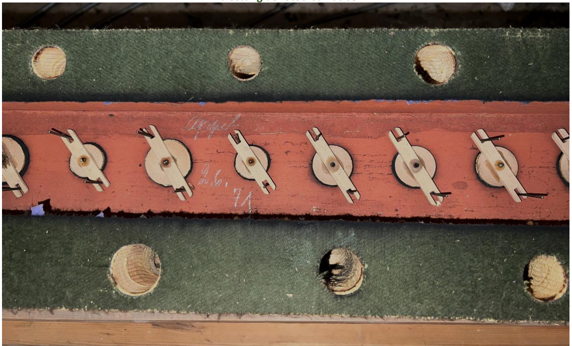
Abbildung 27 Pedal-Kegellade mit Bolusanstrich
